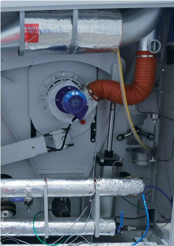
蒸気/オイル配管側 手動で調整可能なロール排気制御用スロットル。
