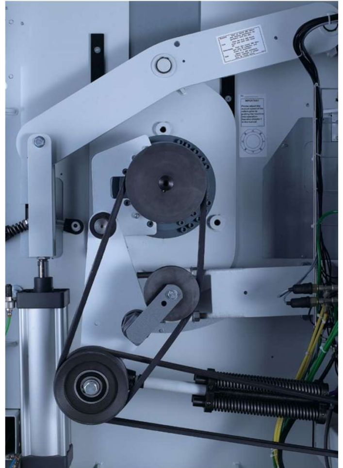
駆動側 遊星ギアによりカウンタートルクを最小化し、調整可能なVベルトプーリーにより各ローラーの速度を独立して調整可能。
