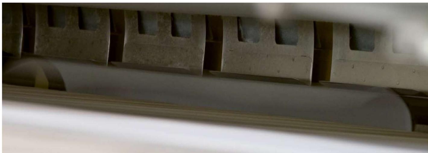
アイロナーテープを使わずに、リネンをロールから分離するスクレーパープレート
